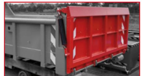
befahrbare Pendelklappe mit Federentlastung
